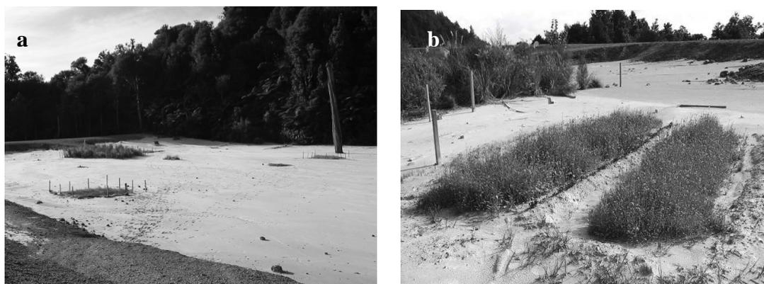
Figura 3. Visão geral da bacia de rejeitos (a) e bloco experimental antes da aplicação do Na<sub>2</sub>S<sub>2</sub>O<sub>3</sub> ao substrato (b), Mina Tui, Te Aroha, Nova Zelândia.
